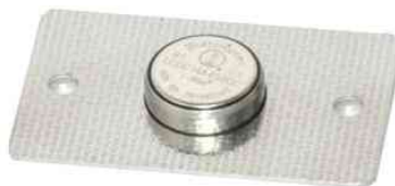
Рисунок 2: Крепление точек контроля
